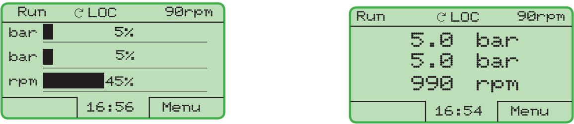
Figura 20.3 - Ejemplo de la HMI en el modo monitoreo para la función Regulador PID
