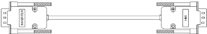
Figura 8.10 - Cable para uso remoto de la HMI
